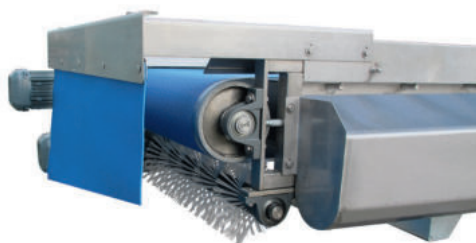
Щетка для чистки в позиции выгрузки сетчатого ленточного фильтра
