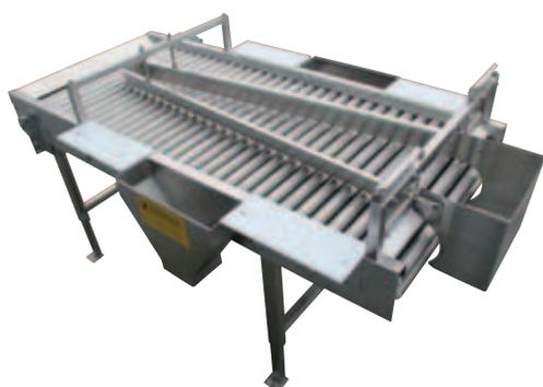
Table d'inspection à rouleaux avec trémies de triage, barres séparatrices et planches à découper
