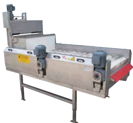
Secadora de cilindros con removedor eléctrico y capote de protección con tubo rociador
