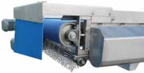
Cepillo de limpieza en la posición de zona de recepción de la cinta de filtración
