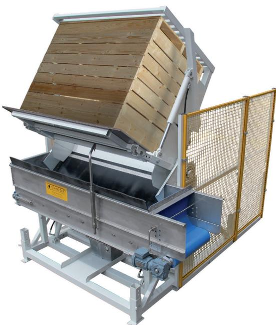
Volcador de cajas con cinta transportadora de descarga en posición de vuelco
